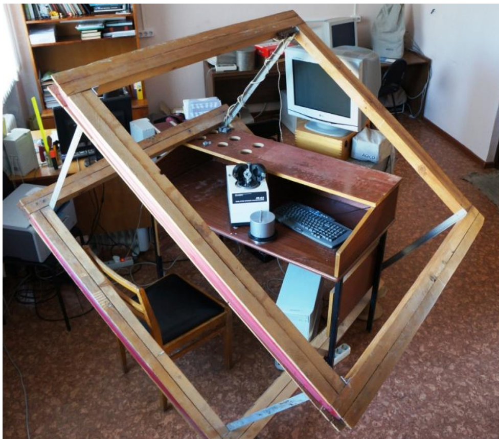
Рис. 2.2. Фотография измерительного блока JR-6A, помещенного в кольца Гельмгольца. Фото автора.
