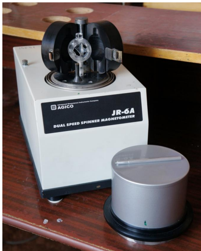
Рис. 2.1. Фотография спин-магнитометра JR-6A. Фото автора.
