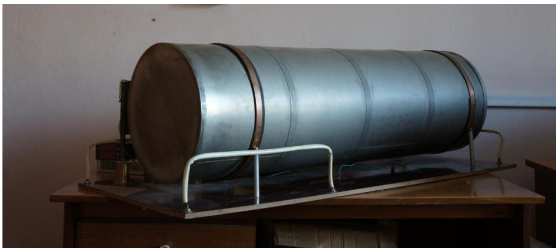
Рис. 2.7. Фотография установки ступенчатого терморазмагничивания. Фото автора.
