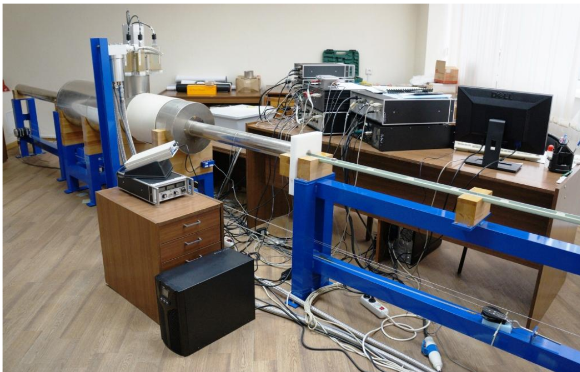
Рис. 2.3. Фотография криогенного магнитометра СКВИД-магнитометр 755-4K SRM. Фото автора.
