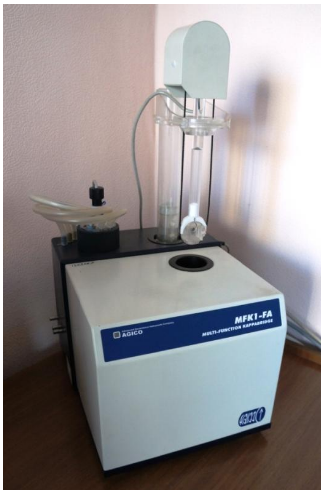
Рис. 2.4. Фотография статического мультимастотного измерителя магнитной восприимчивости – каппа-мост MFK1-FA (производство AGICO, Брно, Чехия). Фото автора.
